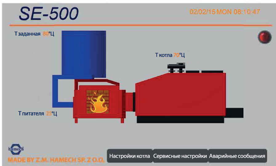
Сенсорная панель контроллера для комплексов KWH+AZSD мощностью 180 кВт и выше.
